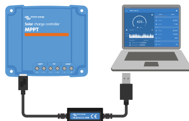
Anslutning av appen VictronConnect via USB med ett VE.Direct USB-gränssnitt
